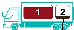
Anschließend werden der aggressive Schlamm sowie Rückstände und Ablagerungen vollständig in die Kammer „2“ des Saug-Druck-Fahrzeugs gesaugt.
